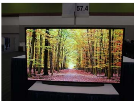
图 1 AUO 的 IGZO 驱动 65 英寸 4K OLED 显示器
