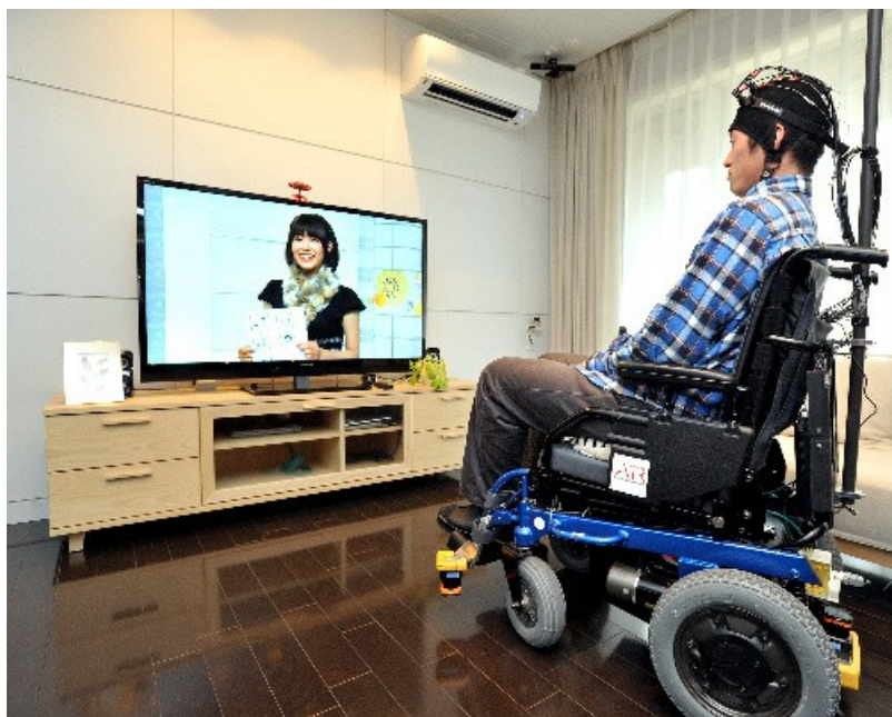
日本国际电气通信基础技术研究所(ATR)与日本电信电话(NTT)公司等公开的仅用意念就可以操控电视、空调等技术的实证试验现场
