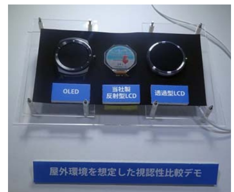
比较在室外使用的视认性。左起依次是 OLED 屏、反射型液晶屏、透过型液晶屏
