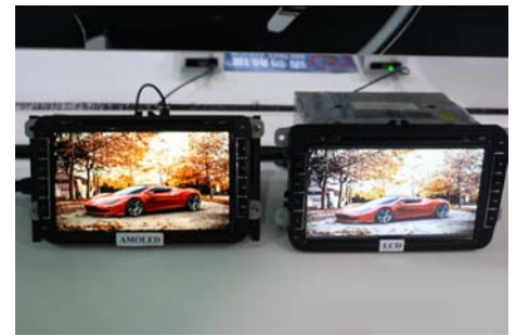
和辉光电用在车载导航平台上的 AMOLED 产品
